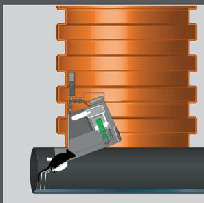
Beim Zurückziehen des Kolbens rutscht die Ratte nach hinten aus der Falle und auf den Boden des Abwasserrohres.
