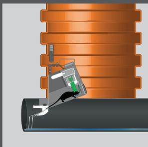
Die Ratte bewegt sich auf den Lichteinfall in der Falle zu und löst einen durch CO2 aktivierten Kolben aus.
