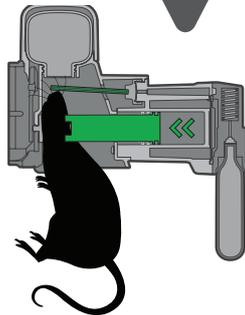
Wenn die Ratte oder die Maus in der Falle ist, wird die CO<sub>2</sub>-Einheit aktiviert, die einen Kolben in der Falle auslöst, der die Ratte oder die Maus tötet. Das Tier stirbt schnell und human.
