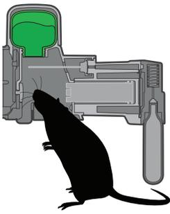
Die Ratte wird von einem speziellen Duft angezogen und geht durch eine zylinderförmige Öffnung in die Falle. Die Öffnung in der Falle ist für das Fangen von Ratten und Mäusen konstruiert.
