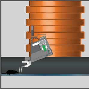
Der Zugang der Ratten zum Abwasserkanal werden mit einer effektiven Rattensperre blockiert.
