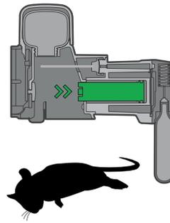
Die tote Ratte oder Maus fällt auf die Erde unter der Falle, die sich automatisch wieder in die Ausgangslage zurückstellt. Für ein optimales Betriebsergebnis muss lediglich der Duftbehälter alle sechs Monate ausgetauscht werden.
