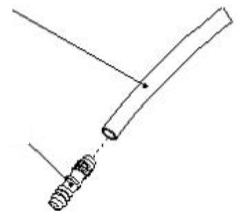
Abb. 3: Verbindung von Verstärkungsschlauch und Schlauchverbindern
